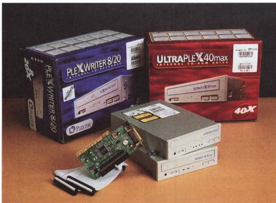
Per realizzare una catena SCSI adatta alla masterizzazione di CD-R è sufficiente utilizzare controller relativamente economici come l'Adaptec AVA 2904CD oppure l'IOI-4201. Le loro prestazioni sono eccedenti le necessità e il loro costo ampiamente abbordabile. In più è possibile connettere alla medesima "catena" altre periferiche SCSI come scanner, dispositivi magneto-ottici, Zip...
